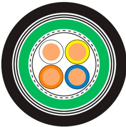
LAPP KABEL STUFGART ETHERLINE® Y2Y ARM Type C Cat.5
